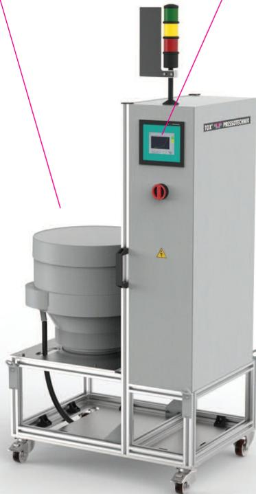
제어장치가 있는 기본 프레임과 feed 시스템용 전기식 드라이브. 이상적인 구성은 하나의 장치로 hopper, feeder bowl, 제어 장치 및 전기식 드라이브로 구성됩니다.
